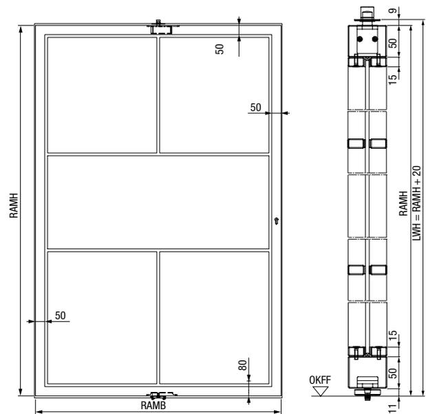
Pivottür in Standardausführung mit 50 mm breitem Rahmenprofil und 50 mm hohem Sockel, Motiv 2
