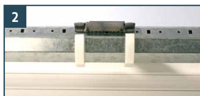
Schnellverbinder und Befestigungsringe auf die Welle legen
